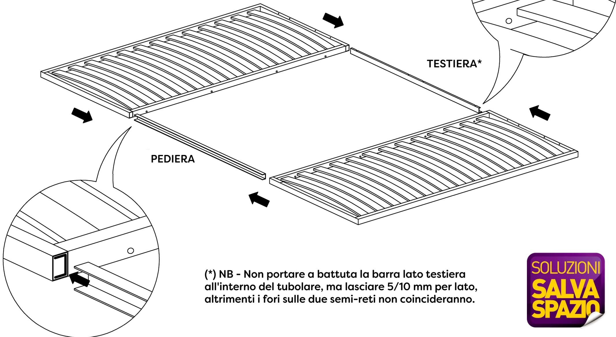
(\*) NB - Non portare a battuta la barra lato testiera all'interno del tubolare, ma lasciare 5/10 mm per lato, altrimenti i fori sulle due semi-reti non coincideranno.
