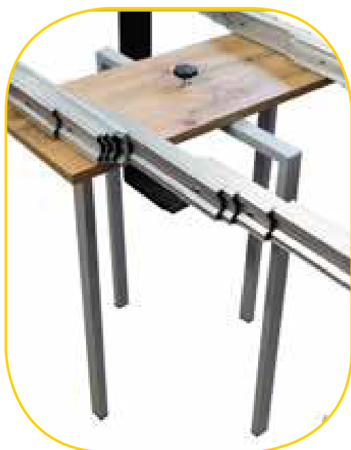
Montaggio con sostegno a 4
