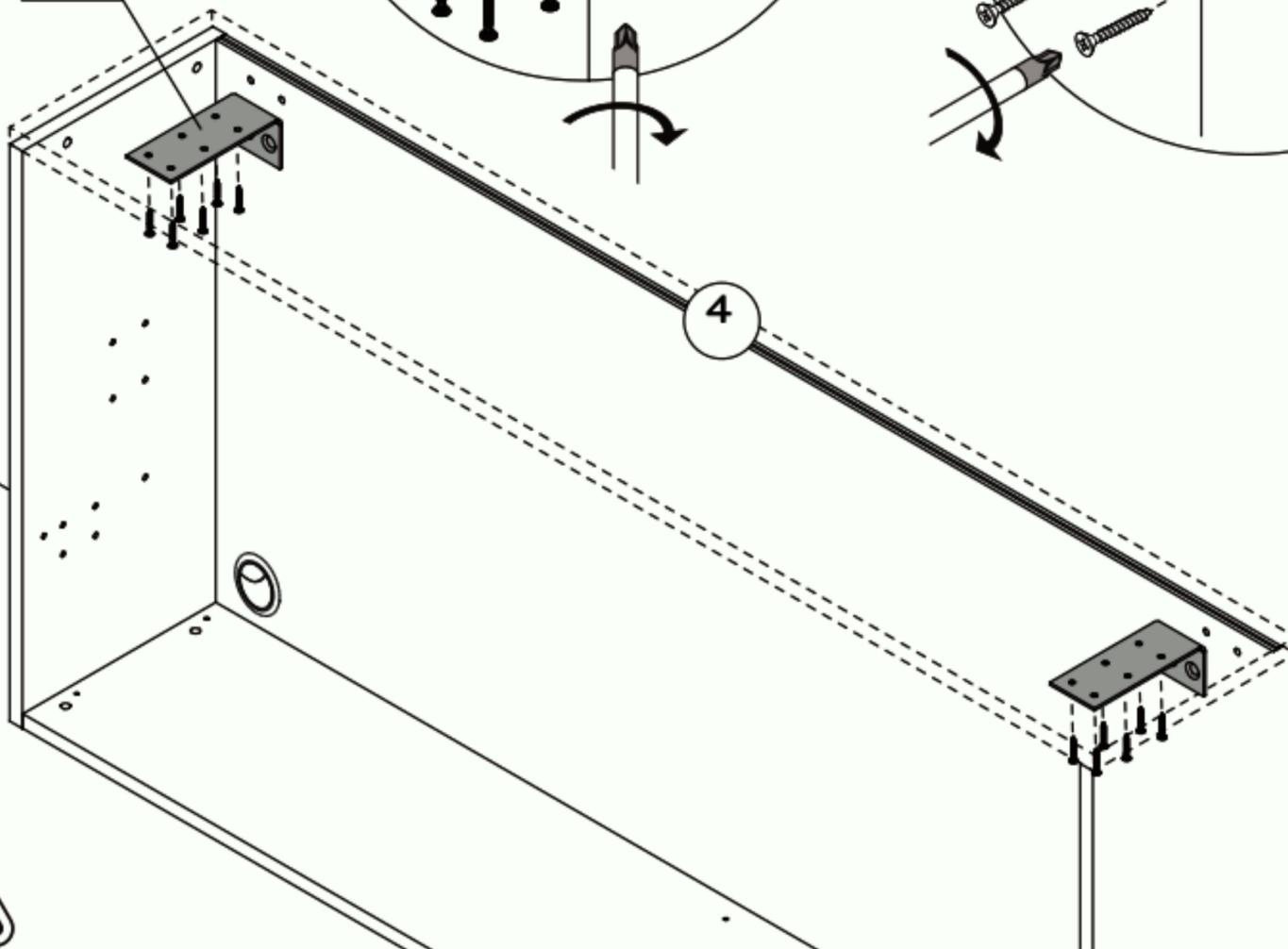
**IMPORTANTE:** l'accoppiamento vite + tassello + muro deve avere una resistenza a trazione superiore a 150 Newton su ogni singola vite.
