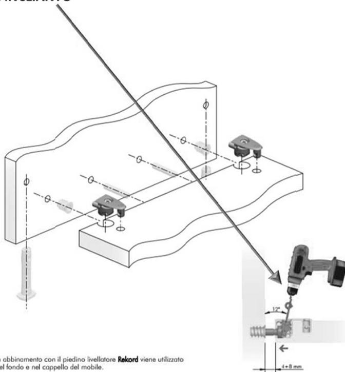
In abbinamento con il piedino livellatore **Rakord** viene utilizzato nel fondo e nel cappello del mobile.
